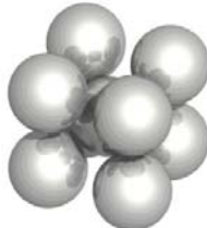
r^{\text{cation}} juste un peu plus grand que r^{\text{trou}} \rightarrow moins de répulsion entre les anions et contact maximale cations-anions
