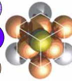
structure cubique compacte (fcc) suite de couches: ABCABC..
