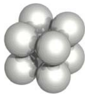
arrangement des sphères compactes cubique avec un trou avec r_{\text{trou}} au milieu.
