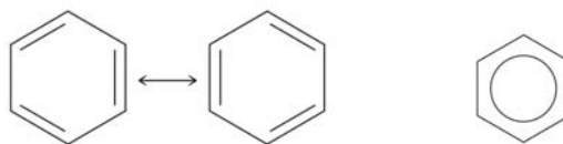
structures de résonance de benzène
